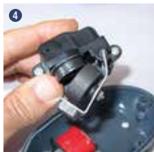
Rimozione della membrana dalla camera d'aria
