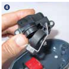
Sortez la membrane du réservoir d'air
