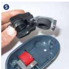
De membraan wordt inclusief magneetbeugel op het rubberlager naar buiten gedrukt
