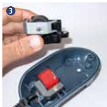
Luftkammer lösen und vom Gehäuse entfernen
