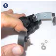
Membrane wird vom Magnetbügel gelöst
