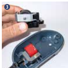
Distacco della camera d'aria e sua rimozione dal corpo
