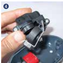
Membrane von Luftkammer entfernen
