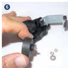
Separar la membrana de la pieza magnética
