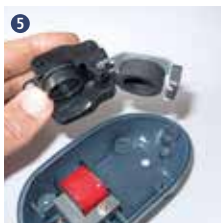
Poussez sur la membrane pour la faire ressortir du silentbloc avec sa fixation magnétique
