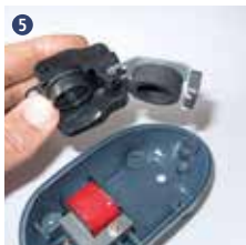
La membrana viene spinta verso l'esterno assieme al gancio magnetico del cuscinetto di gomma
