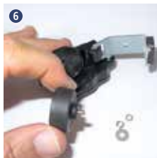
De membraan wordt van de magneetbeugel losgemaakt
